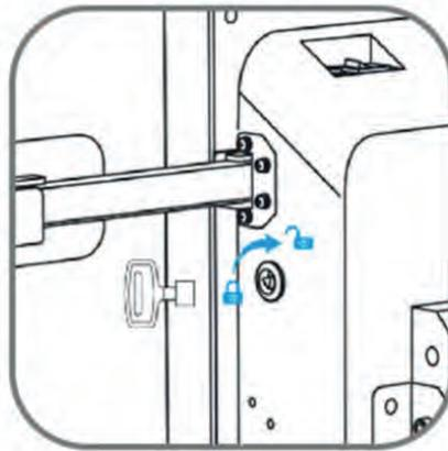
Insira a chave na fechadura do lado direito do Kiosk e vire no sentido horário para abrir o dispositivo. A fechadura do Kiosk possui função reset e irá, automaticamente, trancar quando a porta do Kiosk for fechada.
