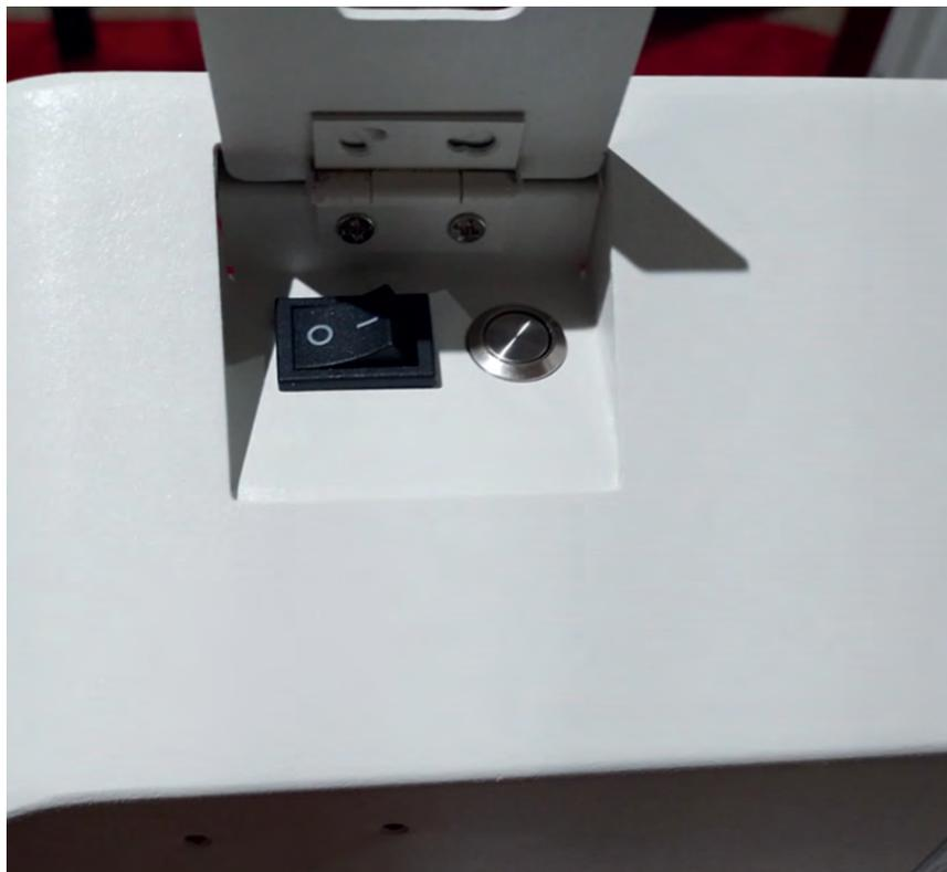
Ligando o equipamento: após conectado o cabo de força na fonte e na tomada de força ou nobreak (**recomendamos fortemente o uso de nobreaks**), selecionar a chave liga-desliga para a posição "I".
