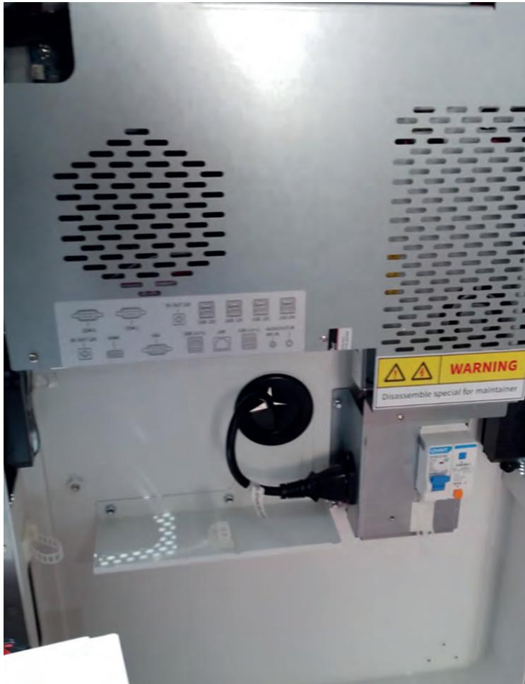
Após fixado o Kiosk ao pedestal, retirar a tampa traseira do pedestal, abrir o Kiosk através da chave de abertura na lateral direita e em seguida passar o cabo com o conector da fonte pelo furo de passagem preto conforme a foto.
